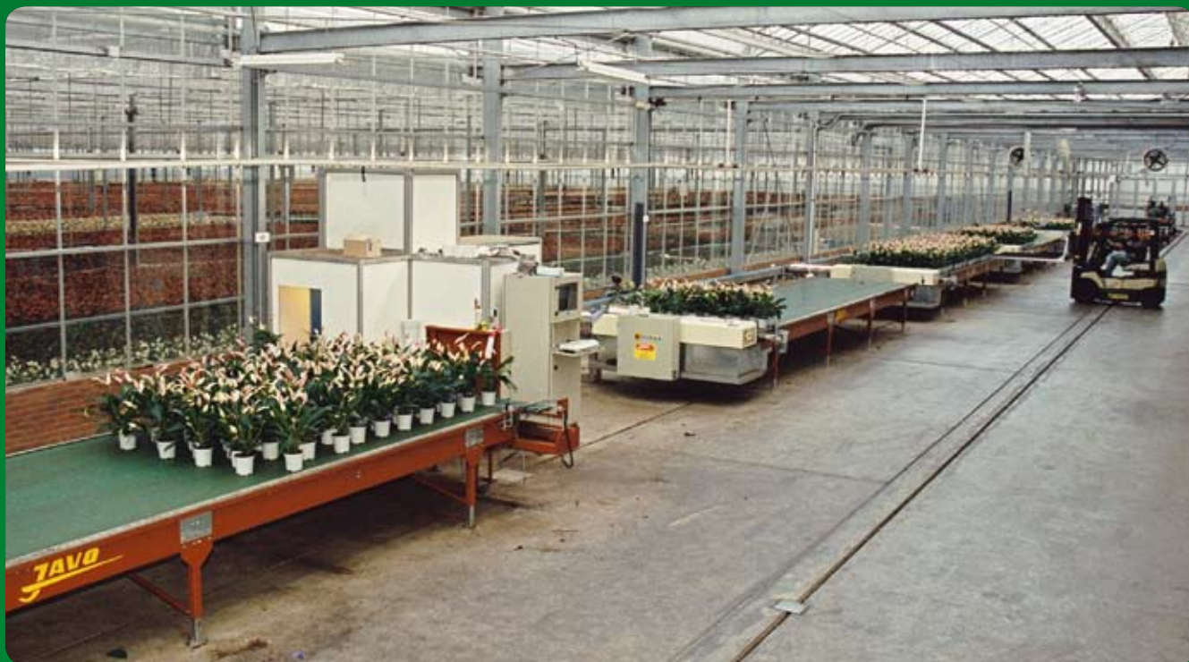
Javo bufferbanden in combinatie met camerasorteersystemen.
